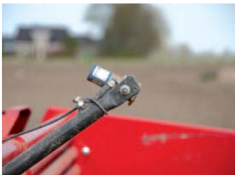
^ Voorraadsensor In de centrale voorraadbak is een sensor gemonteerd die ervoor zorgt dat de bunker iets wordt gegeven als de poothoeveelheid onder een kritische grens terecht komt.
