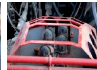
^ Haakse hoek Eenmaal boven maakt de pootketting een haakse hoek en valt één knol in de pootbeker. Eventuele dubbele knollen vallen terug in de voorraadbunker.
