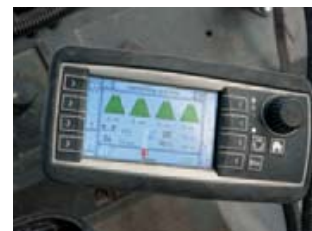
^ Bediening Wifo levert bij de machine een Wachendorf Opus A6-computer, waarmee je het pootproces vanuit de trekker cabine kunt controleren.
