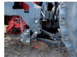
^ Centrale pootbalk Alle elementen hangen aan een centrale pootbalk. Daardoor poten alle elementen even diep.
