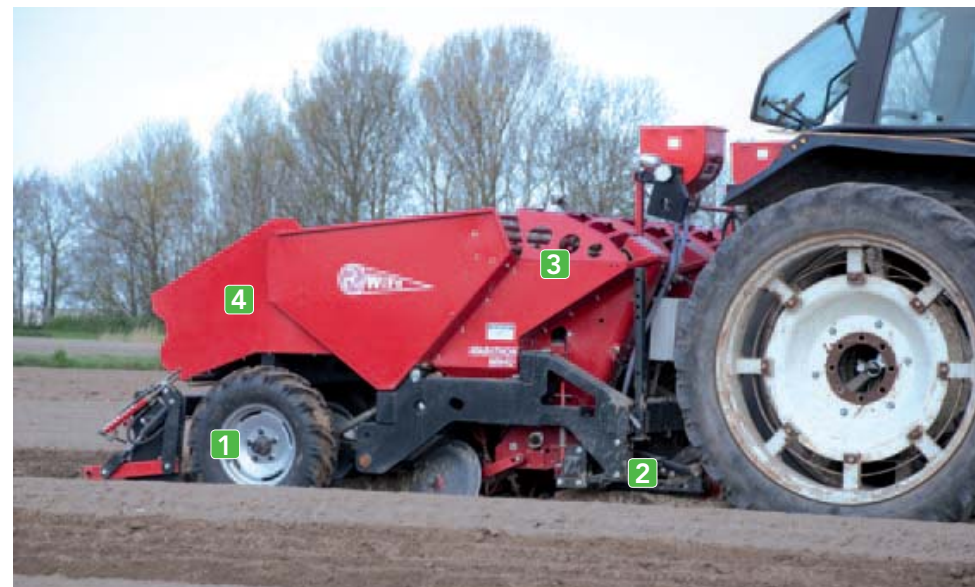
^ Wifo Marathon MH40 De Marathon MH40 is de gedragen variant op de getrokken TH40 die Wifo in 2013 op de markt bracht. De machine rijdt via vier even grote wielen [1] over het land en heeft een centrale pootbalk [2], zodat alle elementen even diep poten. Kenmerkend aan de Marathon-pootmachine zijn de lange lepels [3]. De voorraadbunker [4] heeft een inhoud van 1.800 kg, met een opzetrand is de bunkerinhoud te vergroten tot 2.100 kg.
