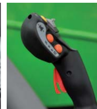
▲ Merlo: bedienen met veiligheid De rode pal moet je bij elke giekfunctie indrukken. Bij heffen/dalen en kantelen gaat dat goed, bij de rolfuncties is het wat lastig.
