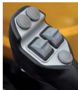
▲ JCB: fijn pookje De rolknop voor telescoperen werkt proportioneel. Met de knopjes boven kan de bak schudden. Het powershiftknopje is net te zien.
