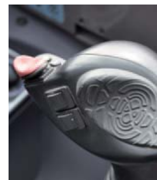
▲ Manitou: ergonomisch gevormd De Manitou-joystick ligt prima in de hand, ook voor de rolfuncties (met de duim) en het rode powershiftknopje (met de wijsvinger).
