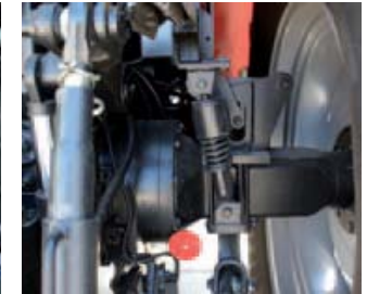
Twee veerpoten aan de achterkant van de cabine zorgen tegen een prijs van 960 euro voor prima rijcomfort. Een geveerde vooras kost 4.770 euro.
