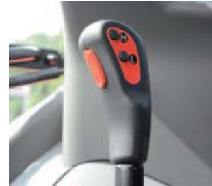
De bediening van de powershift loopt via de knopjes H en L. Aan de voorzijde zit een knopje voor de koppeling.
