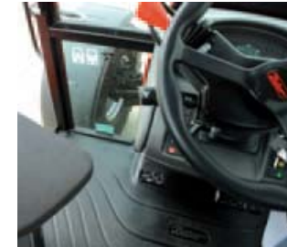
De ruimte tussen het stuurwiel en de bijrijderszitting (ook als die is opgeklapt) houdt niet over. Bij in- en uitstappen is het manoeuvreren.
