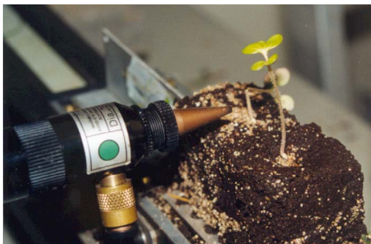
Figuur 3.12 Laboratoriumopstelling van een 25 W laser voor het doorsnijden van gele mosterdplanten voor het experiment van Kurstjens & Vermeulen (2000).
