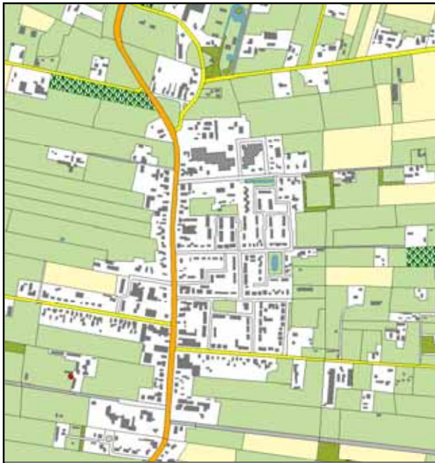
Figuur 14: In de Top-10 bestaat bebouwd gebied uit een verzameling klassen. Wit staat voor de klasse 'overig gebruik' met daarbinnen de gebouwen in grijs. Het gebied met een cluster van overig gebruik met gebouwen behoort tot bebouwde kom. De 'los' gelegen erven in de omgeving zijn geïnterpreteerd als woonerven. (Top-10, TD-Kadaster)
