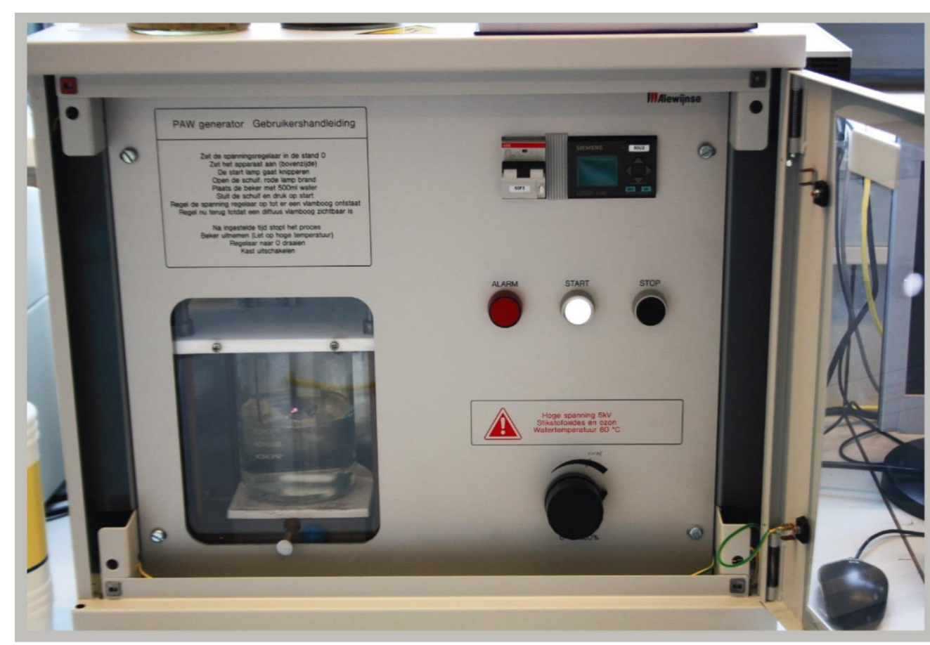
Figuur 1. Een plasmagenerator prototype van de firma VitalFluid, bedoeld voor de kleinschalige productie van plasmawater voor onderzoeksdoeleinden.
