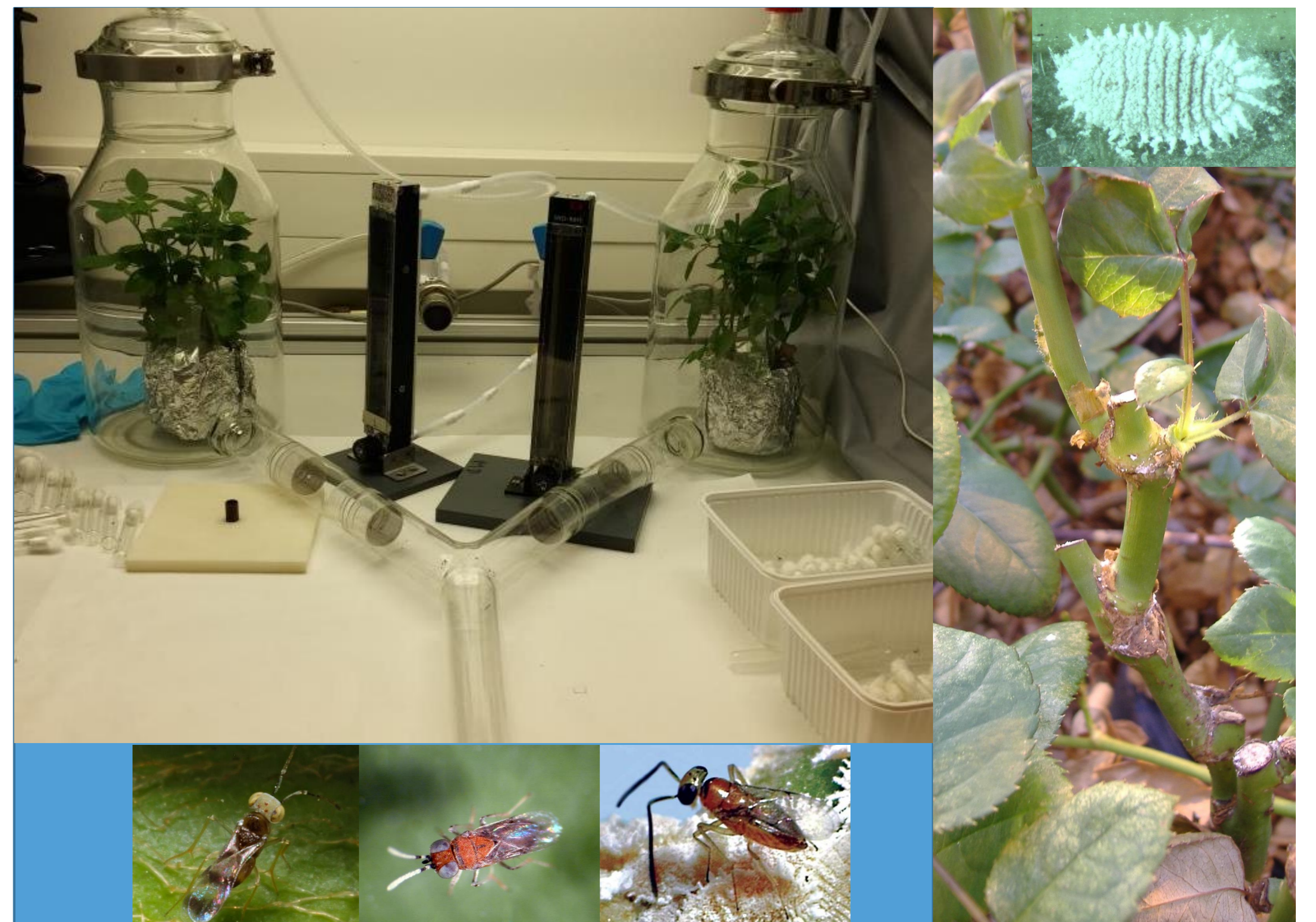
Figuur 2. Gedragsopstelling om vast te stellen in hoeverre getrainde en ongetrainde sluipwespen specifiek afgaan op de geur van een met wolluis-besmette potroosplant (links). Schade van wolluis in snijroos (rechts).
