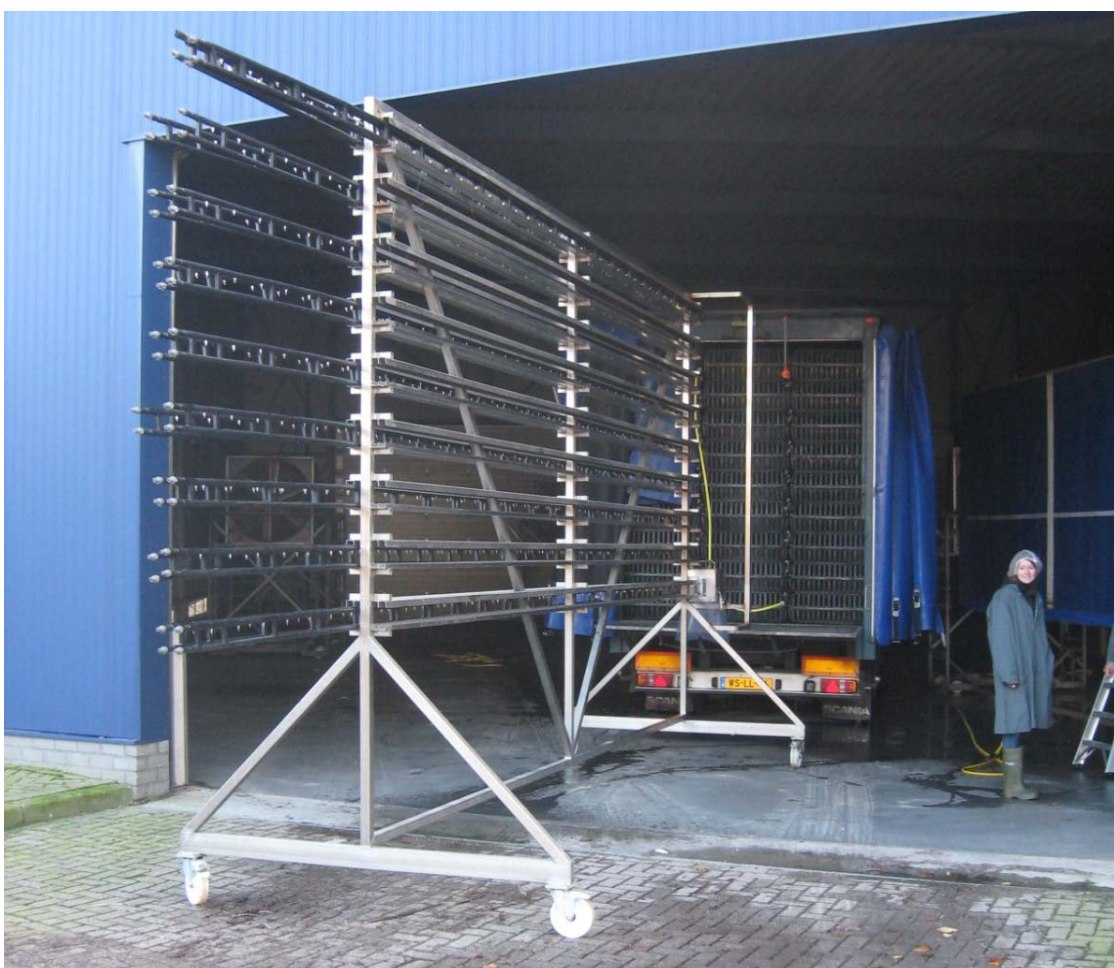
Figuur 10; Opberg- en inbrengstellage voor het drinkwatersysteem
