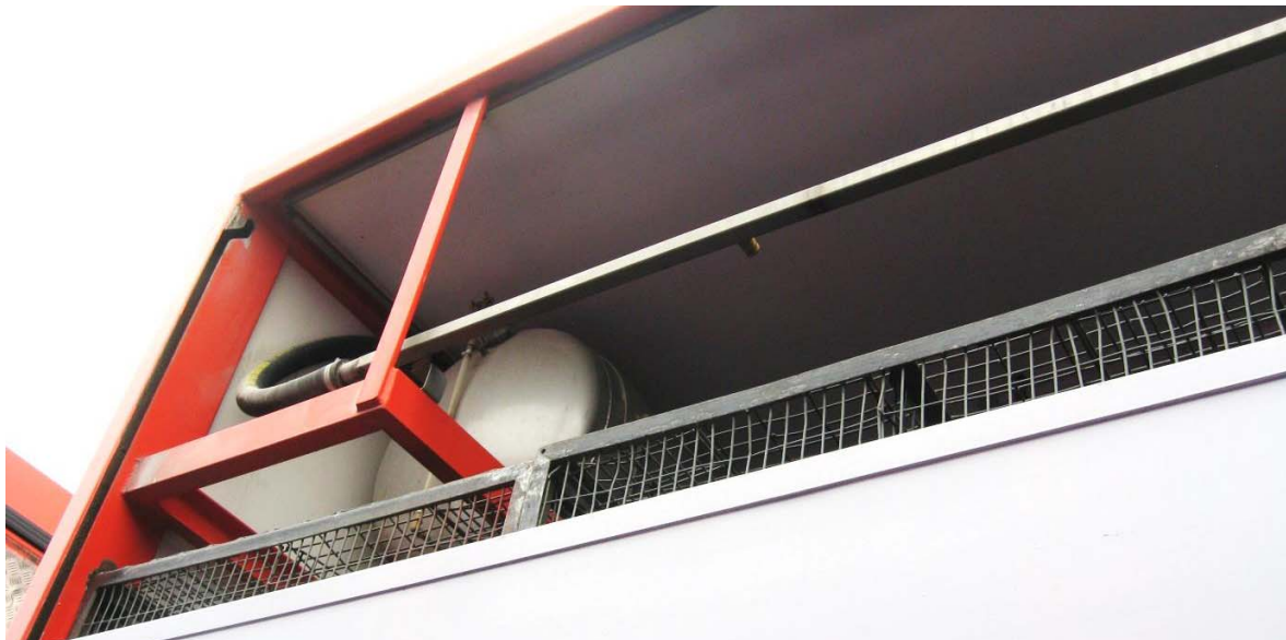
Figuur 5: Drinkwatervoorziening in de vrachtwagen: De voorraadtank bovenin is verbonden aan een vast leidingensysteem, waaraan de rubber slangen van de containers bevestigd worden.
