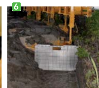
[3] De voorscharen zijn in hoogte, breedte en hoek instelbaar met pennen. De zwarte beschermkap zorgt voor bescherming.
