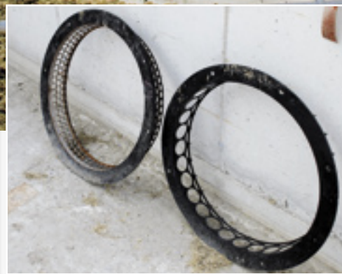
Verwisselbare zeven bepalen de haksellengte.
