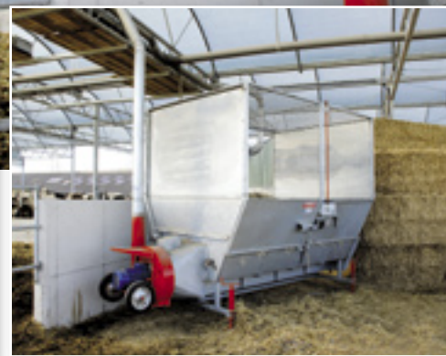
Een elektronisch slot zorgt ervoor dat de bunker niet open kan als de machine werkt.
