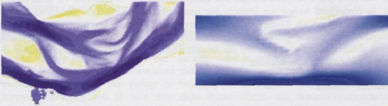
Fig. 10. Westerschelde bij Baarland. Links een gemeten patroon van elkaar ontmoetende eb- en vloedgeulen, rechts een patroon verkregen met een morfologisch model van een rechthoekig estuarium op basis van Delft3D. [Zie ook: A. Hibma et al., Channel and shoal formation in estuaries , Proc. RCEM 2001 Symposium, Obihiro, Japan]
