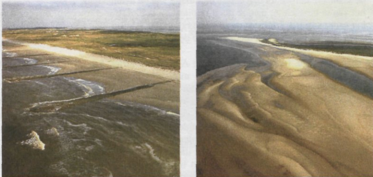
Fig. 19. Geforceerd (links) en vrij gedrag (rechts) van een kust; de strandhoofden op de linkerfoto leggen een vaste structuur op aan de morfologie van het strand; op de rechterfoto is er minstens zo veel structuur, zonder dat deze opgelegd wordt door enige constructie of obstakel.
