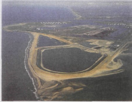
Fig. 3. Slufterdam, Maasvlakte. Voorbeeld van een op basis van vergelijkend morfologisch modelonderzoek ontworpen constructie. [Bron: Liverpool/Thessaloniki Network. European Coasts, an introductory survey . ERASMUS-contract ICP 92-G-2013]
