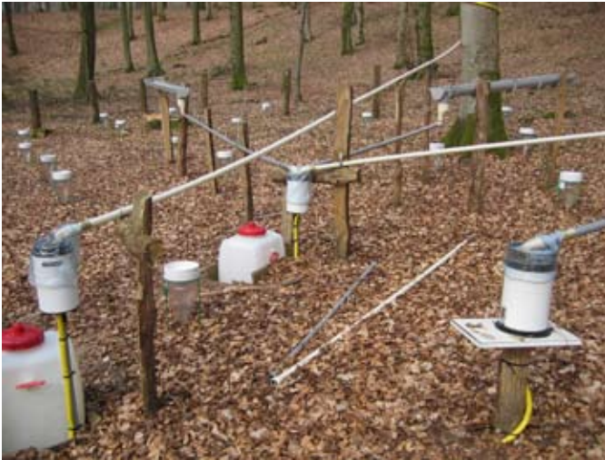
Figuur 3: Doorvalmeting in Luxemburg. Door middel van 81 regenmeters en lange half open buizen wordt de ruimtelijke spreiding van de doorval gemeten.
