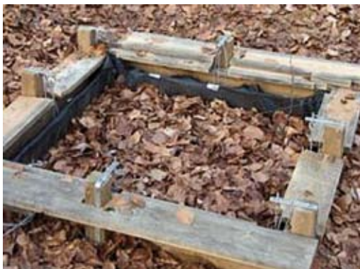
Figuur 2: Forest floor interceptie meetopstelling, met S_u en S_d de berging in respectievelijk de bovenste en de onderste bak. Links een foto van de opstelling in Luxemburg met beukenbladeren.
