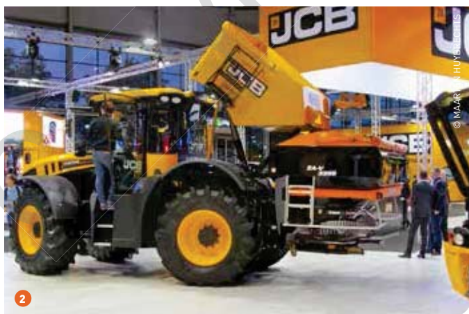
1 McCormick kondigt de komst van zware tractoren aan. Hierbij maken ze gebruik van een gewaardeerde motor en CVT-transmissie. 2 De cabine volledig voor de achteras bouwen verhoogt de veelzijdigheid van de tractor. Eigenaardig dat JCB hierin weinig navolging krijgt.
