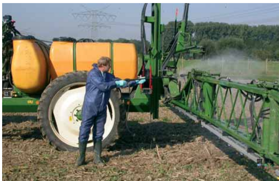
▲ Reinig het spuittoestel na de spoeling van de tank uitwendig in het veld of op een verharde vul- en spoelplaats met opvang voor het restwater.
