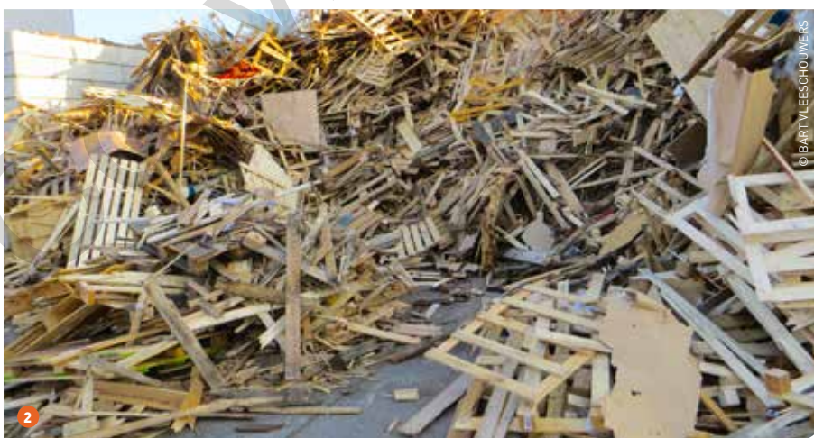
1 De shredder (links) en de trieer- en zeefinstallatie (in het midden). 2 Paletten zijn A-hout en worden daarom gerecycleerd tot spaanplaten.
