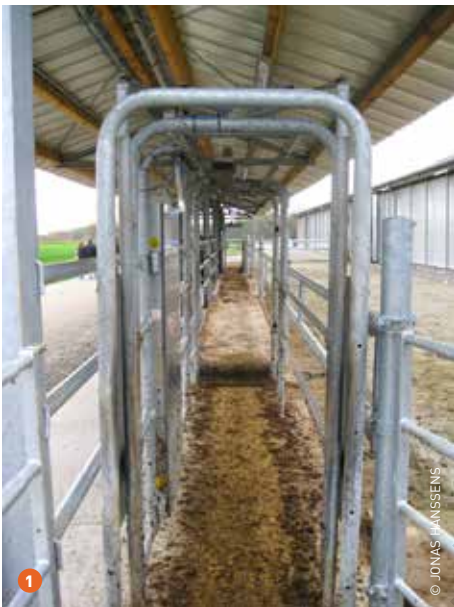
1 Na het melken moeten de koeien door de Gaitwise om terug naar de ligplaatsen te kunnen. 2 De drukgevoelige loopmat is in staat om 90% van de ernstige mankende koeien te detecteren, zonder dat vals positieve dieren worden aangegeven.
