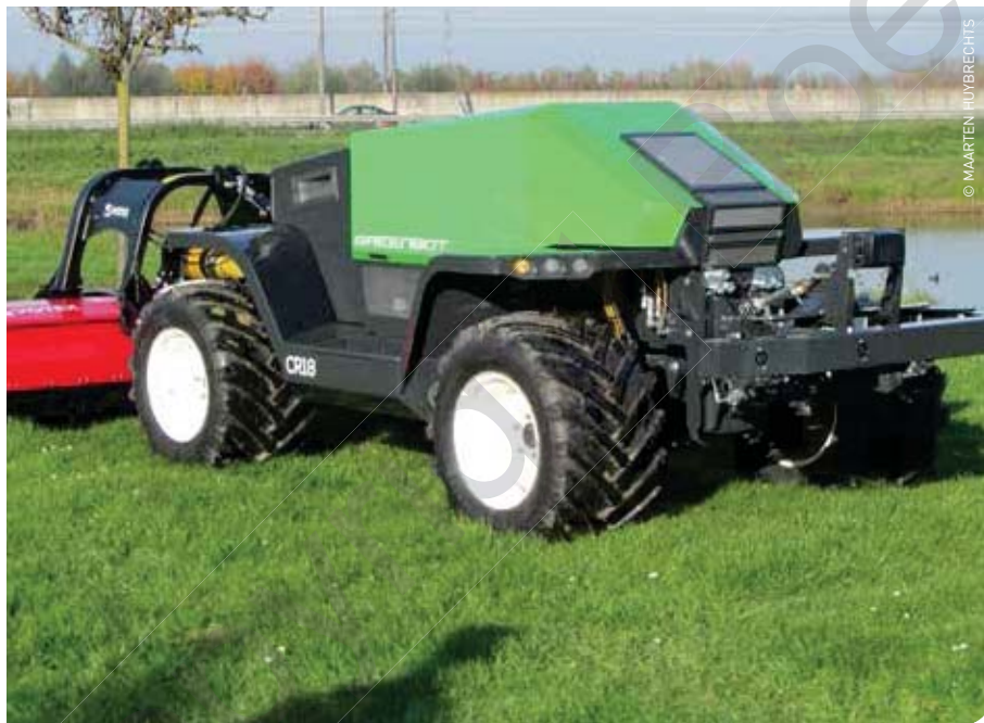
Greenbot kan volledig autonoom werken op basis van een vooraf bepaald programma. Bovendien kan hij autonoom de taken herhalen die vooraf met een bestuurd trekker zijn vastgelegd.
