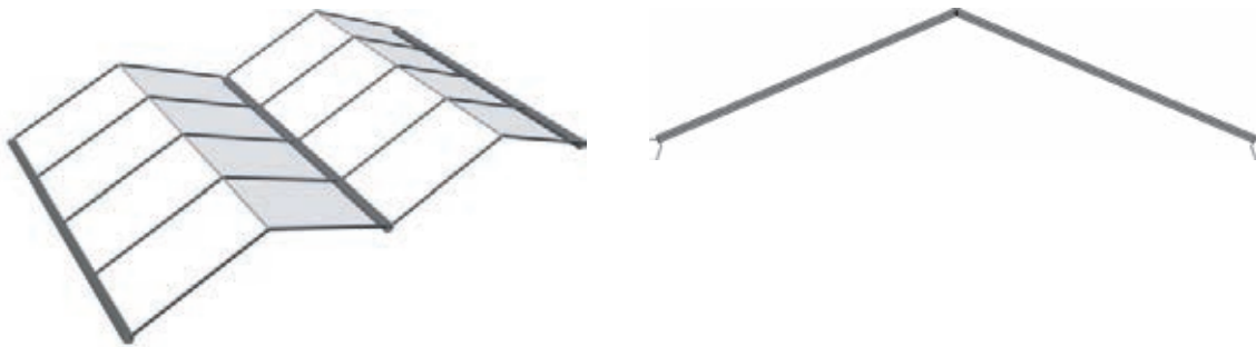
Figuur 2.8 3D model van het referentie Venlo kasdek dat gebruikt is voor de ray-tracing simulaties.
