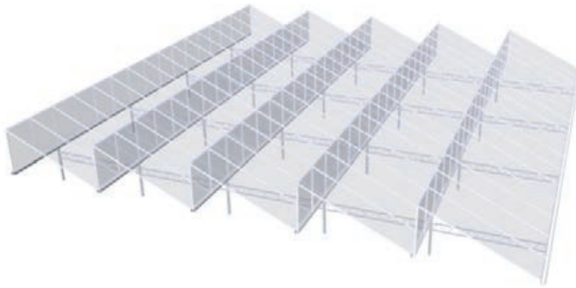
Figuur 3.22 Winterlichtkas met zaagtand dek, spiegelende constructie en diffuus glas.
