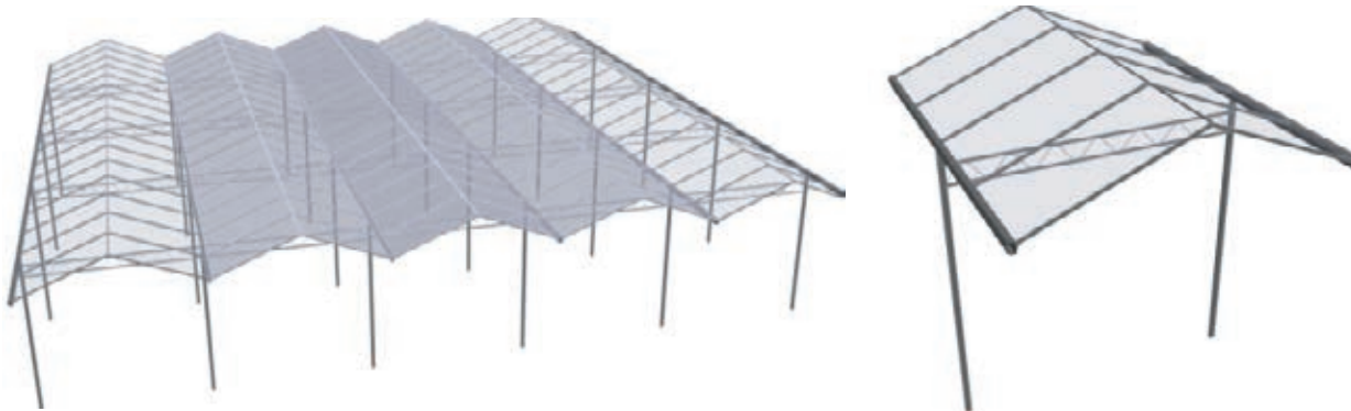
Figuur 2.1 Links: Raypro 3D model van een Venlo kas. Rechts: Door tijdens ray-tracing de kleinste repeterende eenheid een oneindig keer te repeteren in het horizontale vlak wordt het kasdek als oneindig groot beschouwd en treden geen randeffecten op.
