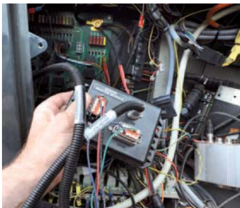
▲ Monteren Het monteren van de sensoren is een tijdrovend en nauwkeurig klusje. Vooral het koppelen aan de gps-ontvanger van de spuit aan de master-module vraagt aanpassingen aan de verbindende kabel.
