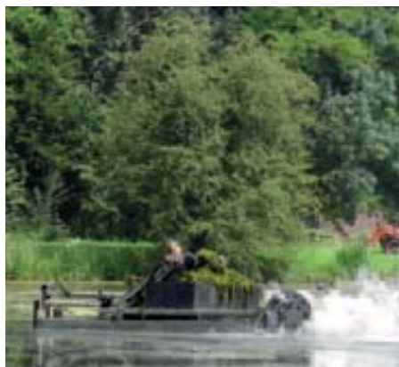
Chris Portengen bouwde een maai-laadcombinatie. De stuwkracht komt niet uit een schroef maar een rad achterop. Het rad voorkomt dat er modder wordt opgewoeld.
