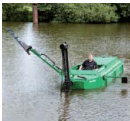
Een verschuifbare motor is bij een maaiboot met zijmaaier vrijwel onmisbaar. Berky daarentegen werkt met een vaste motoropstelling en een uitschuifbaar gewicht.
