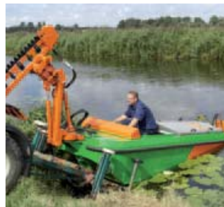
De maaiboot van Van der Knijff uit Moordrecht is klantspecifiek gebouwd. De boot is gebaseerd op een Hemos-maaiboot. Maar met die van Van der Knijff kun je zowel voor, midden als achter maaien, maar ook achteruit.
