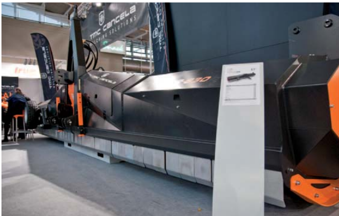
De Spaanse fabrikant TMC Cancela toonde op de beurs een 8,30 meter brede mulcher. De bijna 7 ton wegende TJR gaat in de lengte over de weg.
