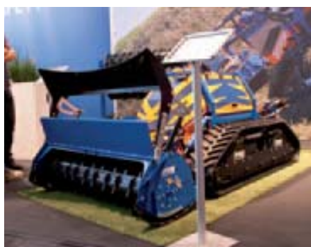
De Spaanse fabrikant TMC Cancela toonde op de beurs een 8,30 meter brede mulcher. De bijna 7 ton wegende TJR gaat in de lengte over de weg.
