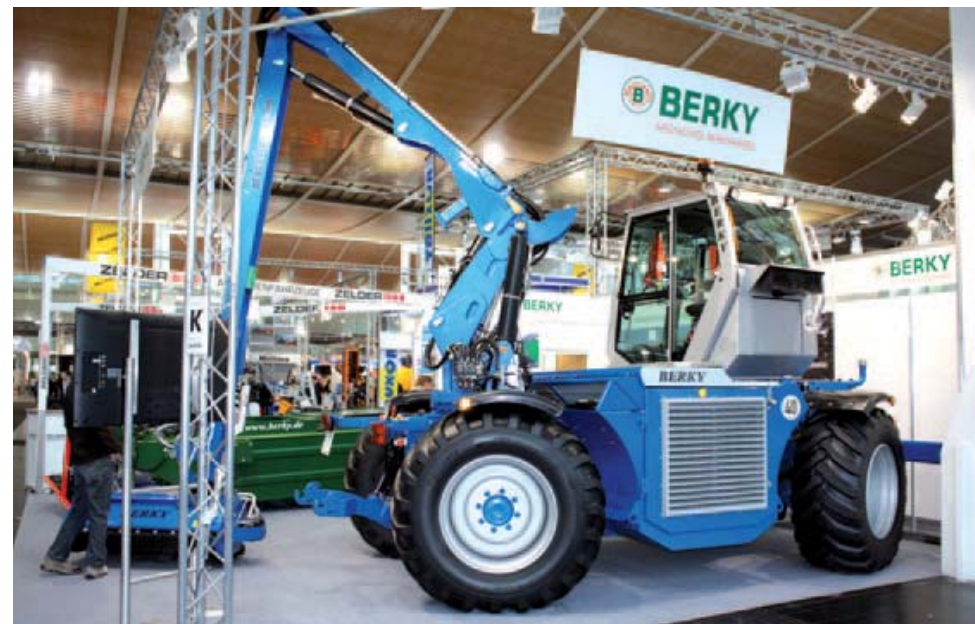
De cabine en werktuigenarm van de zelfrijdende Berky draaien beide 270 graden. Het bereik van de arm is 9,3 meter.
