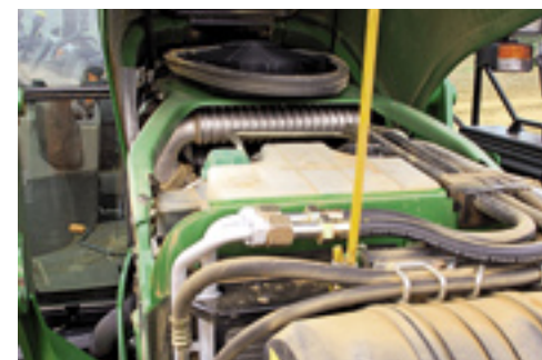
De koeler van de inlaatlucht ligt bovenop de motor.
