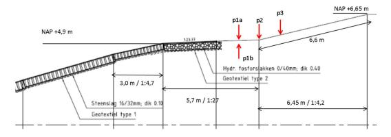
p1a, p2 en p3: drukmetingen op het taludoppervlak
