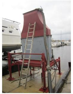
Picture 27. Filling till 3 m water column
