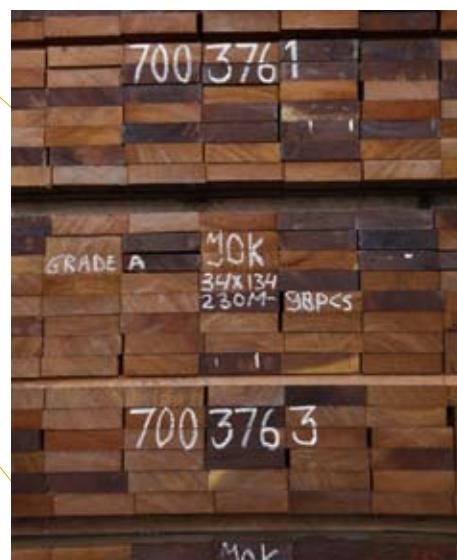
FSC-gecertificeerd Fava Amargosa, geschikt voor GWW-toepassingen als loopdekken, damwanden en beschoeiingen (foto: Mark van Benthem, Probos)
