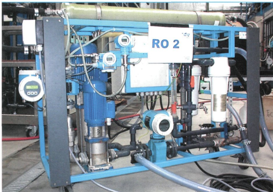
Proefinstallatie met nanofiltratie in Vechterweerd.
