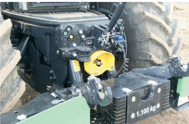
Deutz-Fahr heeft bij de zware ZF-achteras alle denkbare aansluitingen standaard aangebracht, waaronder acht dubbelwerkende hydrauliekaansluitingen, maar ook een Isobus- en een extra camera-aansluiting.
