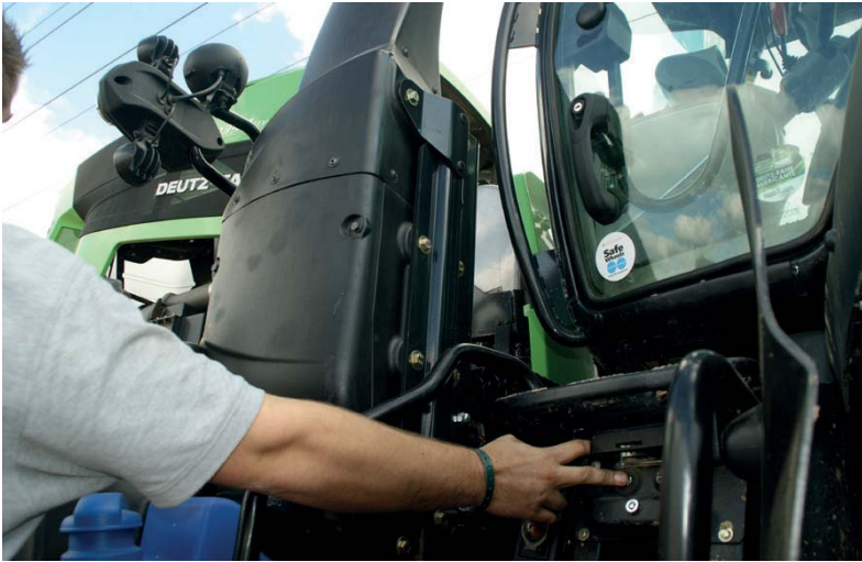
De motorkap kun je via drukknoppen simpel openen. De 7,8-liter- Deutz-Stage IV-motor met zelfreinigend roetfilter heeft dankzij een dubbele turbo al negentig procent van het koppel beschikbaar bij 1000 toeren.
