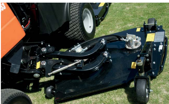
De zijmaaiers zijn van hoogwaardige staal en hebben een parallellogramophanging in combinatie met een luchtveer om ze weer in positie te brengen.
