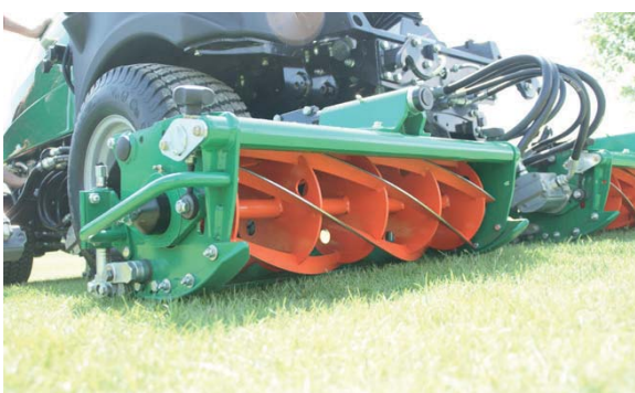
De vijfdelige kooimaaiervariant heeft de bekende kooimaaiers. De ophanging van de zijmaaiers loopt via een enkele arm en de maaiers zijn veerdrukbeveiligd.
