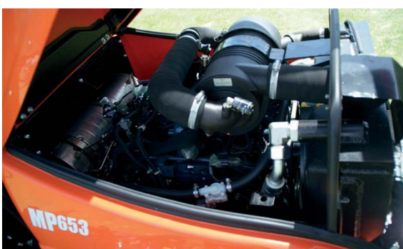
De nieuwe 48 kW (65 pk) Kubota Stage IIIb-motor met een roetfilter direct achter de cabine. De variant met 36 kW (49 pk) heeft geen roetfilter.
