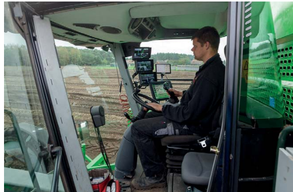
Het weegstelsel werkt voorlopig met een eigen scherm. Het wordt dus nog voller in de cabine. Er wordt gewerkt aan een Isobus-koppeling.
