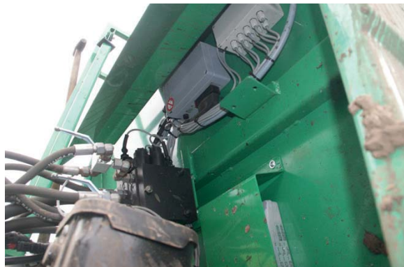
De wagen heeft een regelkast, een Isobus-aansluiting en een weeginrichting. Verder is het vooral de bekende Tebbe-wagen.
