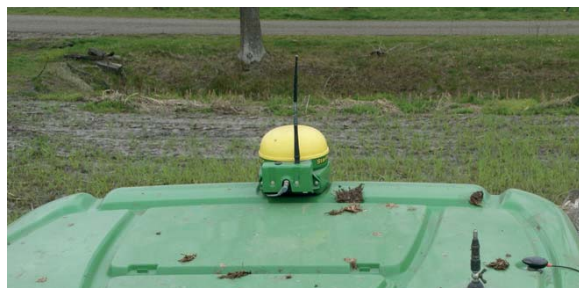
De Tebbe werkt met een eigen antenne voor het plaatsspecifiek uitrijden. Het doseren is niet te koppelen aan - in dit geval - het John Deere AutoPilot-systeem.
