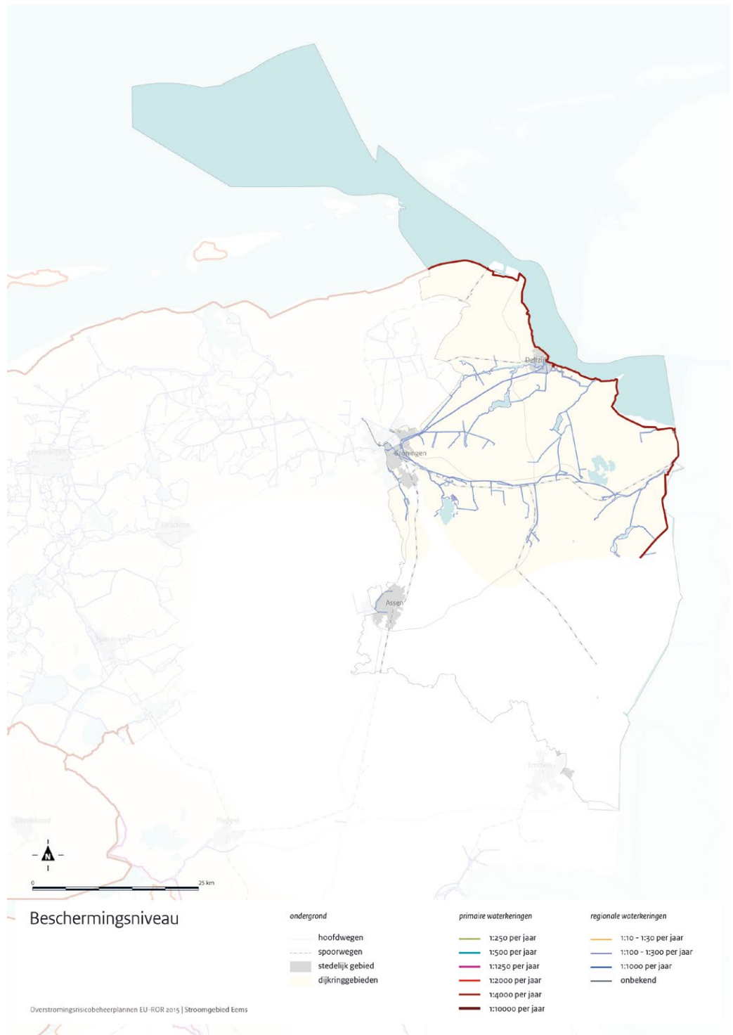
Figuur 4.1 Indeling in primaire keringen (dijkringgebieden) en regionale keringen in het stroomgebied van de Eems 5
