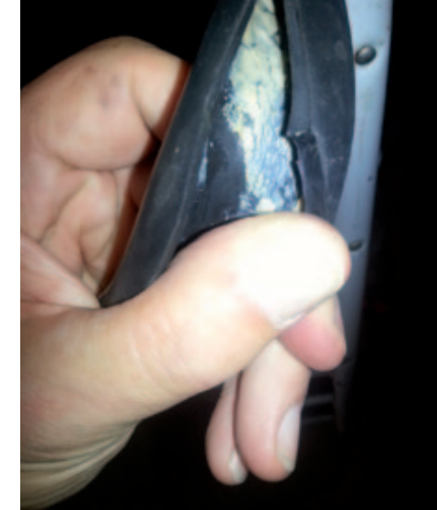
De slang op de melkketel is slecht schoongemaakt. Door luchtstroming kan deze vervuiling ook in de melktank terechtkomen.
