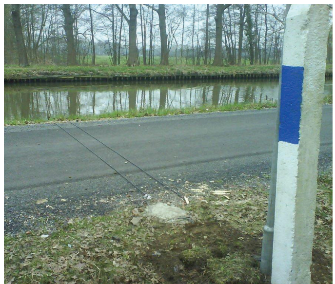
Telsingangen op het wegdek om aantal fietsers te registreren.
