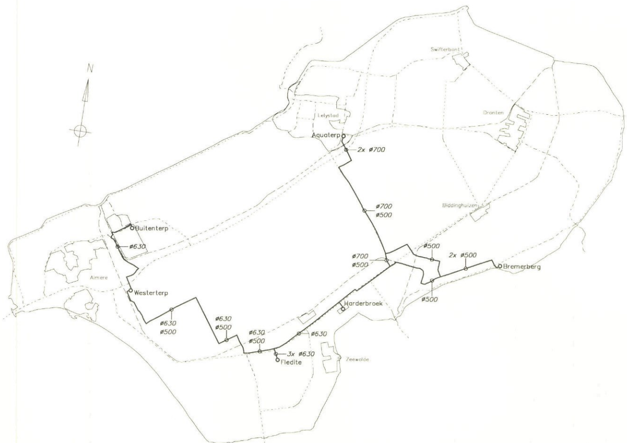
Afb.1 Waterwinstations, drukverhogingsstations en transportleidingen.
