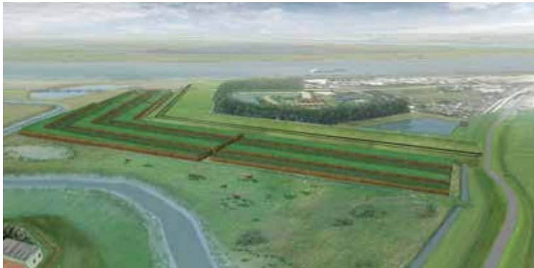
Een artist impression van de toepassing van wilgengriend tegen een waterkering
