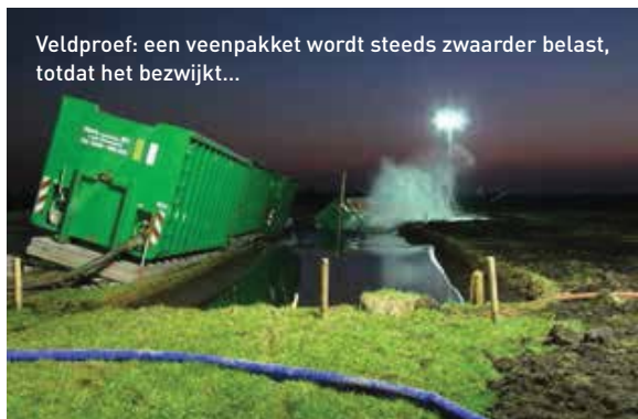
DSS-proef, een onderdeel van het bepalen van de sterkte en het gedrag van het veen in de nieuwe ontwerpmethod
