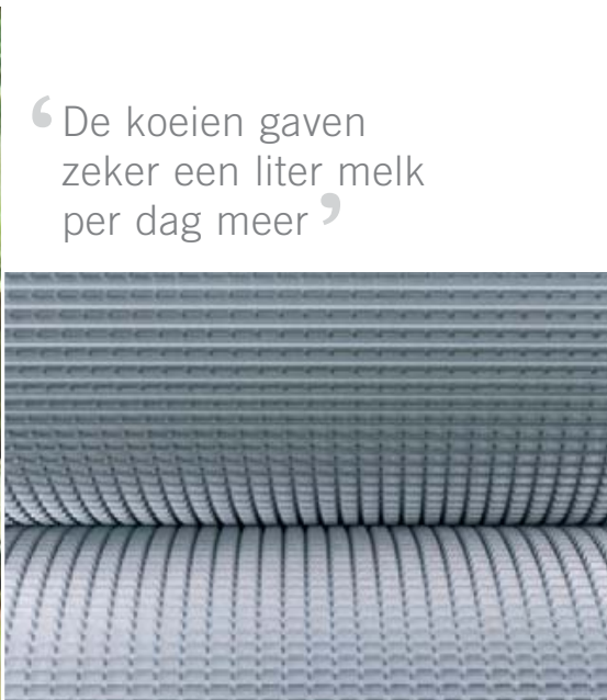
De shredlage- kneuzer heeft een spiraalvormig patroon. Dat patroon verpulvert de korrel en scheurt stengels af. Er blijven dus langere, ruwe stengeldelen over.
