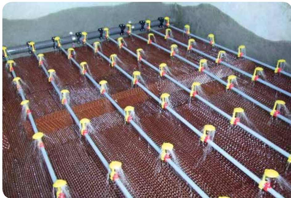
Foto 3. Het substraat in het biofilter is van hard karton. Foto: Dr. Sherif Sadek.
