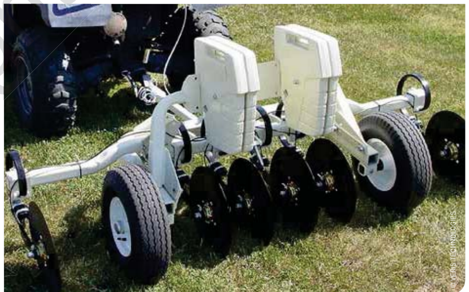
Het principe getoond in figuur 1 in de praktijk. De roterende schijven fungeren als stroom- of potentiaalelektroden. De gewichten zorgen ervoor dat de schijven in de bodem blijven.
