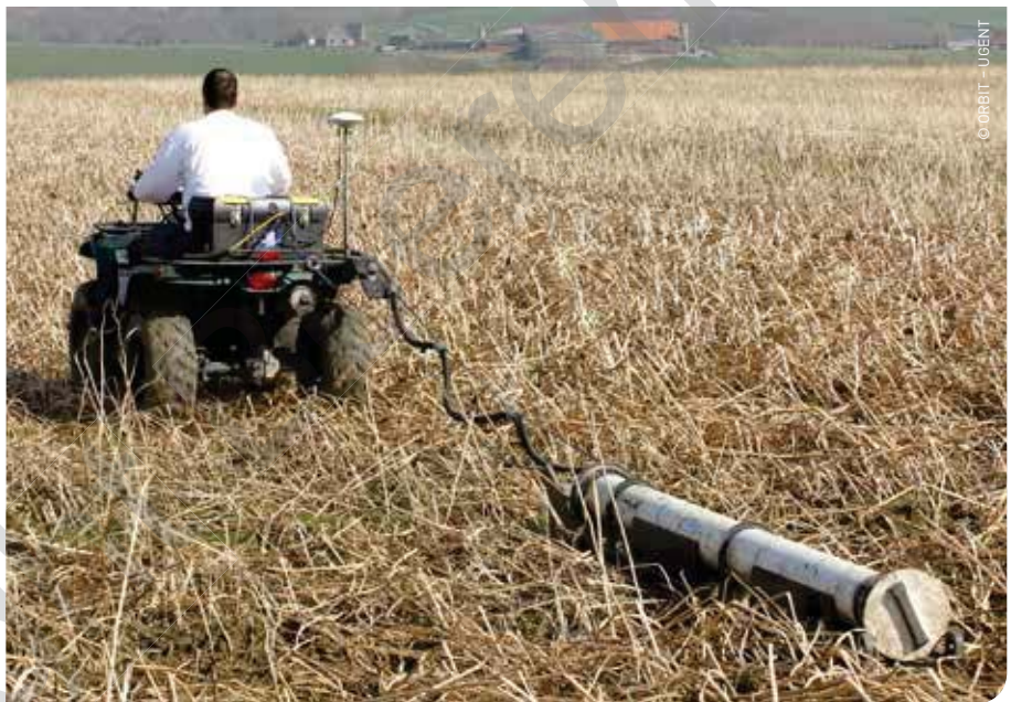
De slede waarin een EMI-sensor getrokken wordt. Deze sensor stuurt continu een magnetisch veld uit dat via meerdere ontvangstspoelen de elektrische geleidbaarheid over meerdere dieptes registreert (in dit voorbeeld over 4 dieptes).
