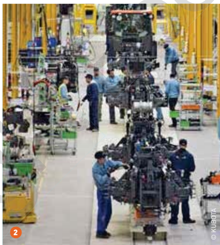
1 De cabines worden geproduceerd in het Japanse Sakai. In Bierne (onderaan) doen ze nog diverse kwaliteitstesten. 2 De assemblagelijijn van de M-serie in de nieuwe Kubotafabriek in het Noord-Franse Bierne nabij Duinkerke. 3 Op het einde van de assemblagelijijn passeert elke tractor een lichttunnel, waar uitvoerig naar onnauwkeurigheden wordt gezocht.
