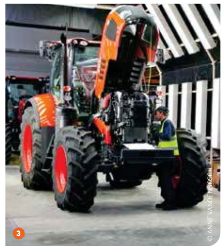
1 De cabines worden geproduceerd in het Japanse Sakai. In Bierne (onderaan) doen ze nog diverse kwaliteitstesten. 2 De assemblagelijijn van de M-serie in de nieuwe Kubotafabriek in het Noord-Franse Bierne nabij Duinkerke. 3 Op het einde van de assemblagelijijn passeert elke tractor een lichttunnel, waar uitvoerig naar onnauwkeurigheden wordt gezocht.
