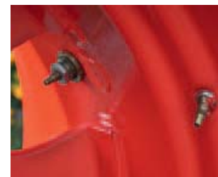
De Air Cell heeft twee ventielen. De diameter is nog te klein en de magneetklep ontbreekt, maar het linkerventiel is van de Air Cell en de rechter van de buitenband.
