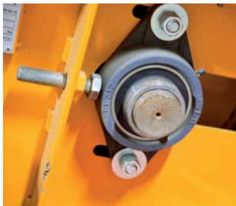
▲ Standaardlagers Spinnekop gebruikt ruim bemeten lagers en assen in de standaardmaten. Gaat er onverhoopt toch één stuk, dan kun je er goed bij om het lager te vervangen.
