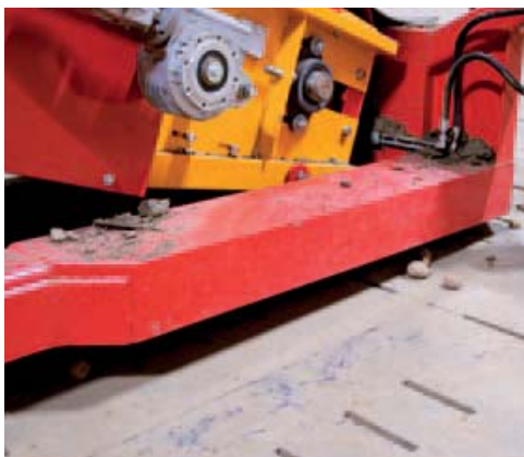
▲ Contragewicht De Spinnekop-hallenvuller is robuust gebouwd. Op staal is niet bezuinigd. Het contragewicht dat de hallenvuller aan de grond houdt, is onderdeel van het frame.
