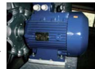
Motorrendement Vanaf 1 januari 2017 zal deze motor een IE3-motor moeten zijn.
