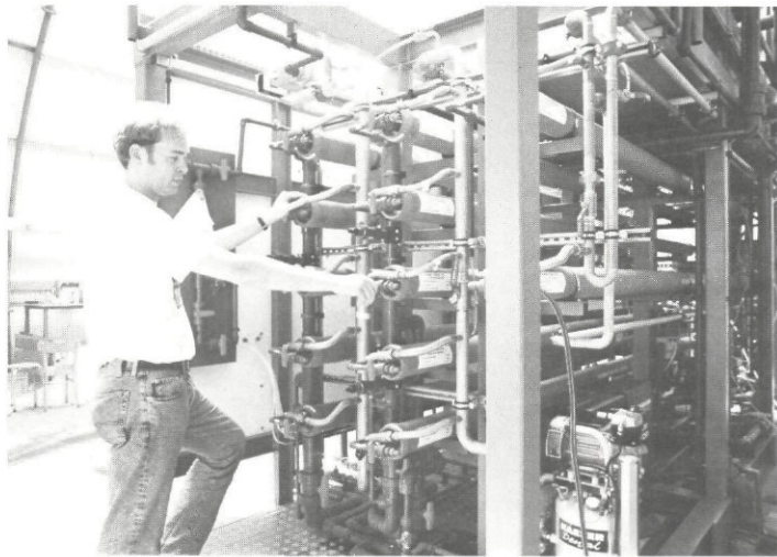
Afb. 3 - De proefinstallatie met nanofiltratie voor ontharding en kleurverwijdering op pompstation Hammerfliet van de NV Waterleiding Maatschappij Overijssel (foto WMO).
