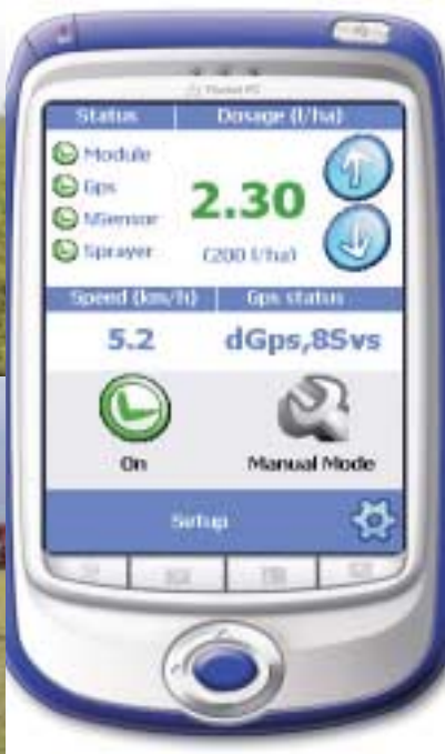
Sensor, injectiespuit en PDA met doseringsmodule voor pleksgewijs doseren van loofdoedingsmiddel in aardappelen.
