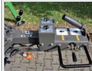
Met de beide draaiknoppen op de stuurdisel is de rijsnelheid tweezijdig regelbaar.
