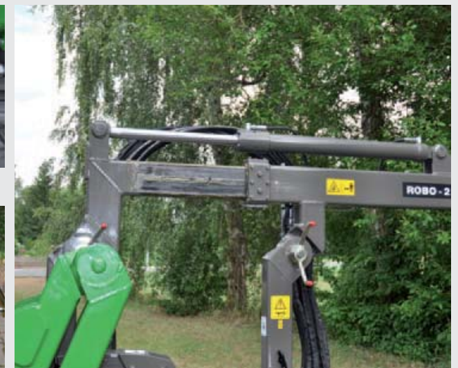
Het horizontale deel van de portaalarm is hydraulisch in- en uitschuifbaar en heeft daarbij een bereik van 60 cm. Dat geeft flexibiliteit bij het passeren van allerlei soorten en maten grafzerken.
