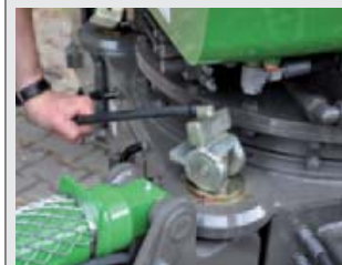
Na het bepalen van de juiste richting klem je de steunpoten met een hefboom vast.
