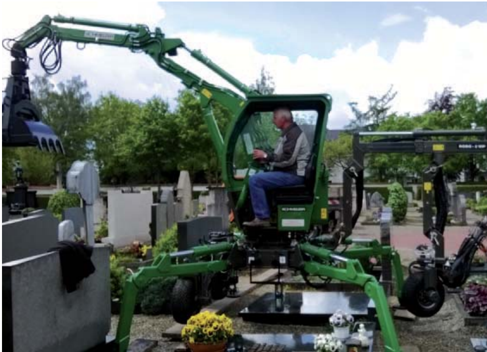
Met zijn sturende wiel aan een portaalarm rijdt de Robo 2WP vanaf een hoofdpad tussen en over de graven door de drie wielen 90 graden te zwenken.
