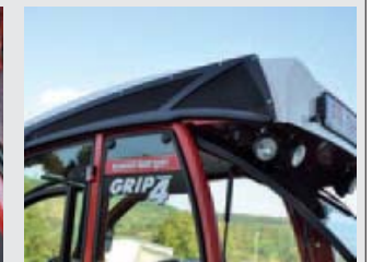
In het cabinedak zitten de airco en het luchtfilter van de motor, dat daardoor altijd schone lucht aanzuigt.
