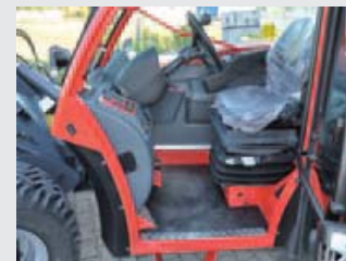
De cabine is ruim, heeft een goede stoel en een stuurwiel dat in twee richtingen ruim verstelbaar is.
