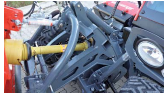
De frontheft van de Sauerburger is bevestigd aan de vooras en volgt samen met die van de contouren van het terrein. De Grip 4 maakt vooral indruk door zijn solide en degelijke bouw. Een bijzonder kenmerk is het hooggelegen scharnierpunt van de vooras; dat geeft extra stabiliteit.
