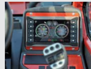
Het instrumentenpaneel van de Grip 4 is geheel elektronisch. Op de voorgrond de multifunctionele rijhendel.
