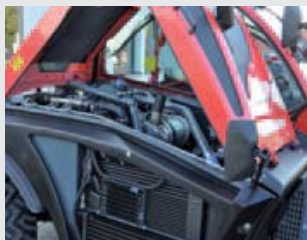
De viercilinder Perkins is dankzij de tweedelige motorkap goed bereikbaar. De koelers (op de voorgrond) zijn uitklapbaar.
