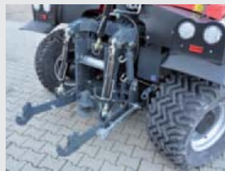
De hef achter is zoals de versie aan de voorzijde een integraal deel van de Grip 4. Hij tilt 1,9 ton. De hefstangen zijn twee topstangen.
