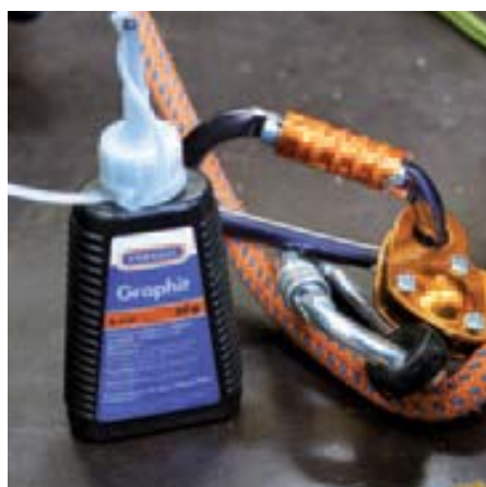
Sluitingen van karabijnhaken moeten schoon en gangbaar zijn. Je kunt ze smeren met grafietolie.
