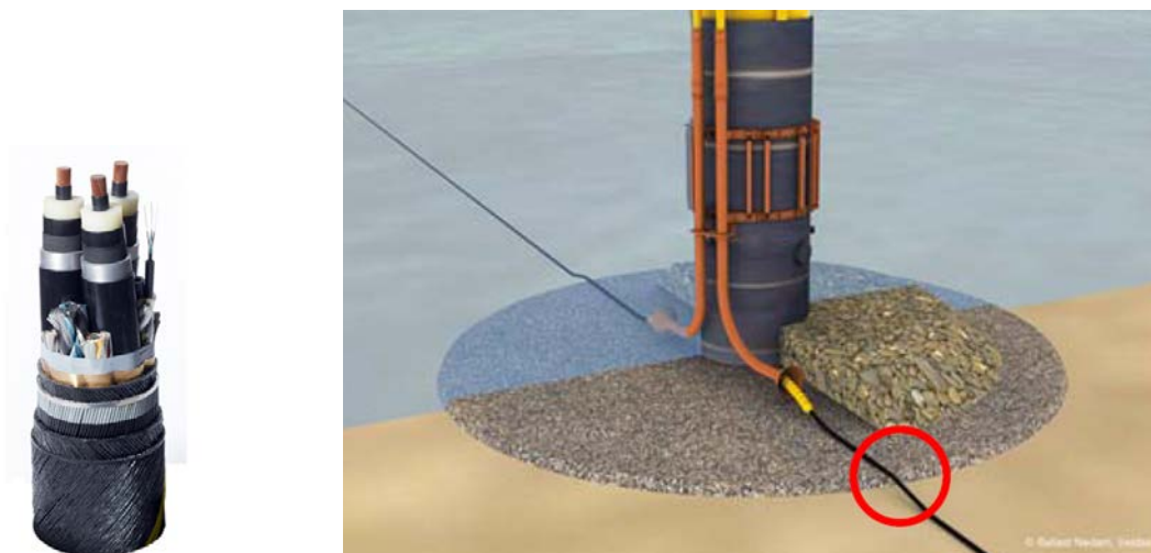
Figuur 5. Foto van een opgesneden offshore zeekabel met de drie geleiders (links). Schematische weergave van bekabeling. Hier is te zien dat bekabeling onder stortstenen maar boven de filterlaag door het zand binnen treedt (rechts). Bron:
