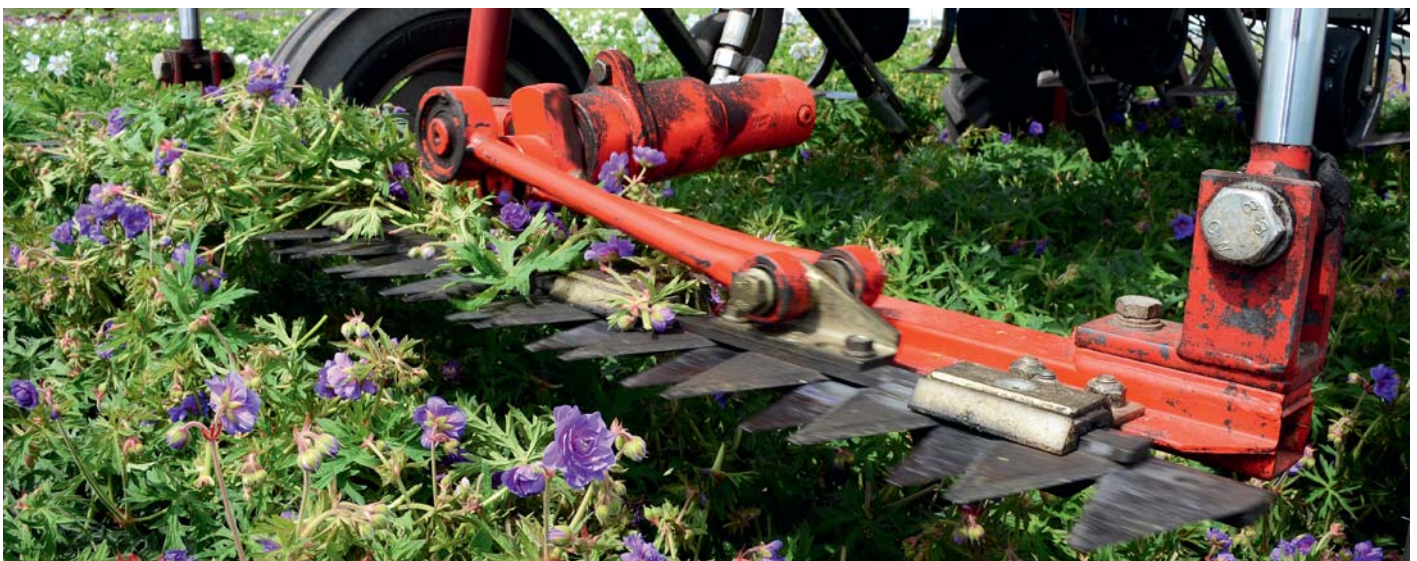
Een goed in hoogte verstelbare maai balk is onontbeerlijk
