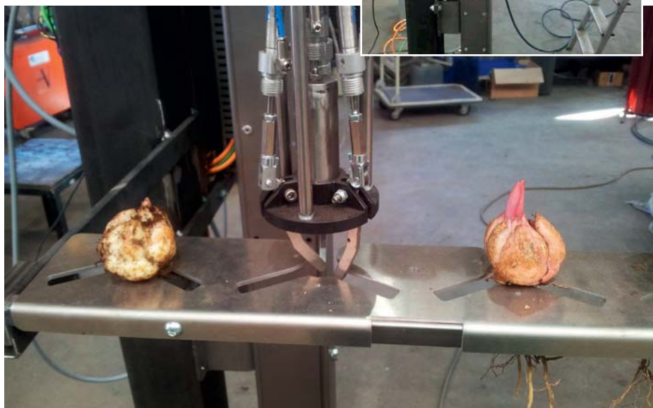
De robotarm die bollen in het geboorde plantgat moet planten
